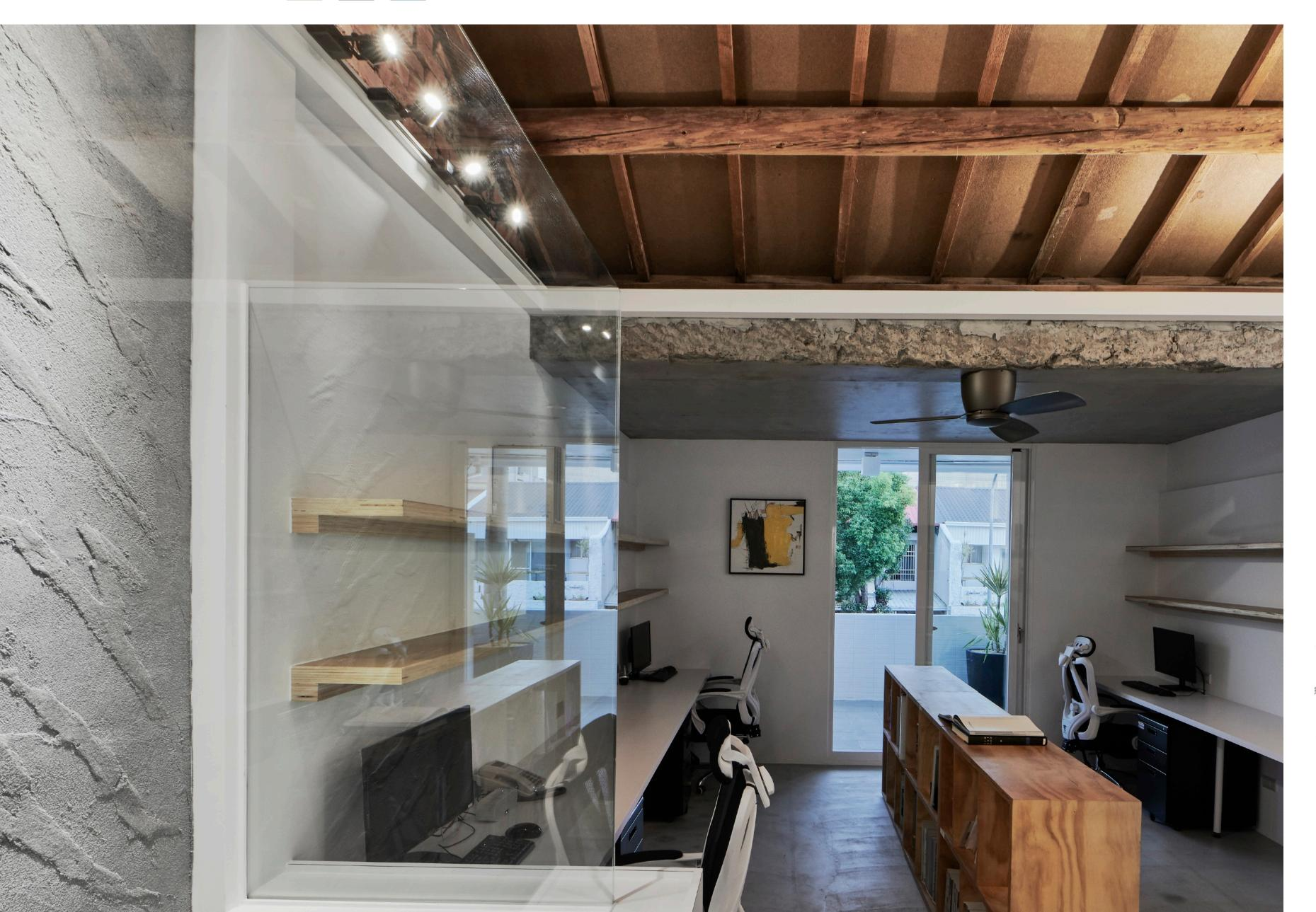
牆面延續40年老屋的原始樣貌,請師傅以沙岩漆塗繪 出手感紋路,增添時光背景的韻味及空間中的趣味 性。我們亦拆除原先屋主多加的裝潢,僅透過單純的 材料本質,如甲板、角料、水泥粉光等,建構二樓的 辦公空間;並因應建物原有的斜屋頂條件,保留紅磚 的透氣孔,讓空氣對流順暢,達至冬暖夏涼的舒適感 受。
